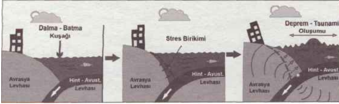
Şekil 2 : Dalma-batma kuşaklarında tsunaminin oluşumu.
